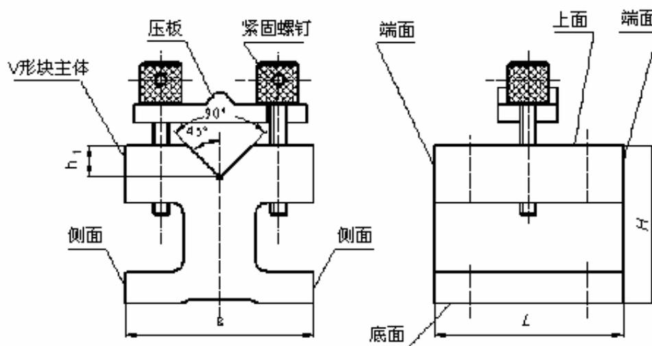
图1 I型V形块（带一个V型槽或紧固装置）
