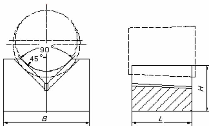
图4 IV型V形块（带一个锥度V型槽）
