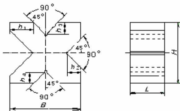
图2 II型V形块（带四个V型槽）
