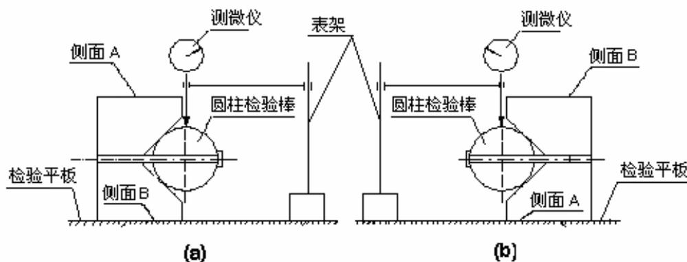
图 6 检验 V 形槽对两侧面的对称度
