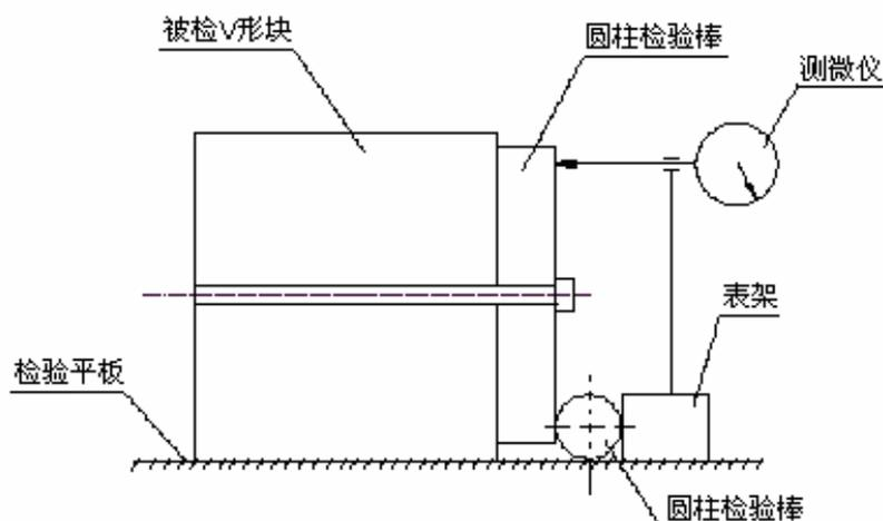
图8 检验V形槽对端面的垂直度
